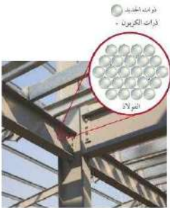
الفولاذ محلول صلب من فلز الحديد والكربون.
